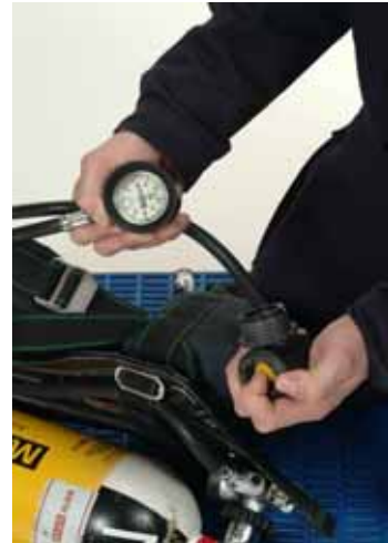
Sichtkontrolle und Kurzprüfung des Pressluftatmers
