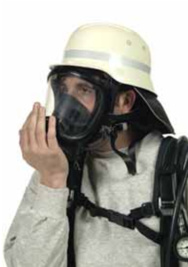
Nachdem der Feuerwehrhelm und die Vollmaske angelegt ist, erfolgt die Maskendichtprobe
