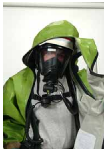
Lungenautomat an Vollmaske anschließen
