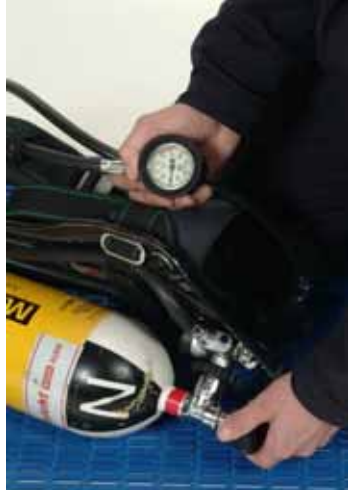
Sichtkontrolle und Kurzprüfung des Pressluftatmers
