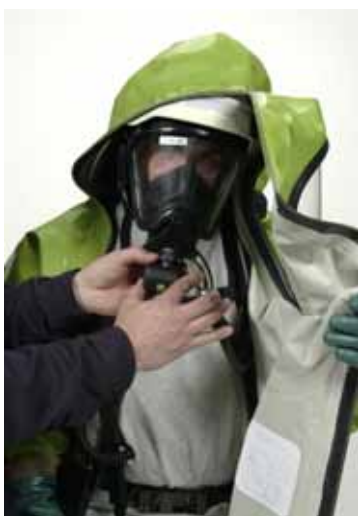
Lungenautomat an Vollmaske anschließen
